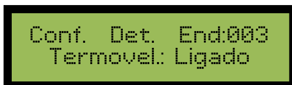
Figura 50 - Habilitando ou Desabilitando a termovelocimetria
