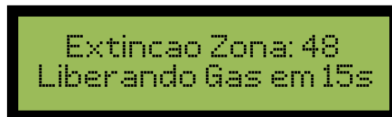
Figura 29 - Temporização para disparo do gás extintor
