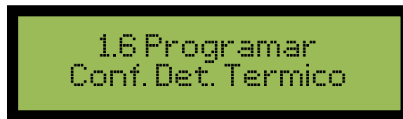
Figura 46 - Menu de configuração dos detectores de temperatura
