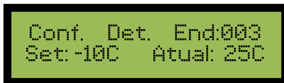
Figura 49 - Setpoint com a temperatura negativa
