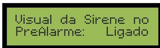
Figura 62 – Alterando a condição do visual da sirene no Pré-Alarme
