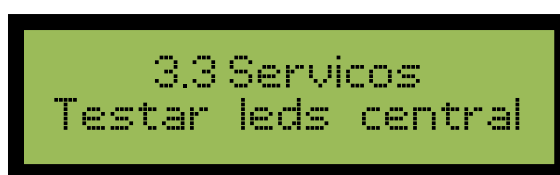
Figura 70 - Menu para testar todos os leds
