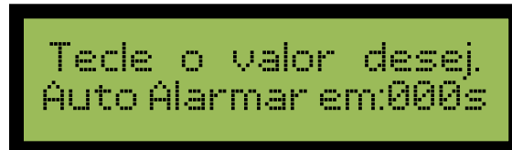
Figura 53 - Configuração do tempo em segundos para alarme geral
