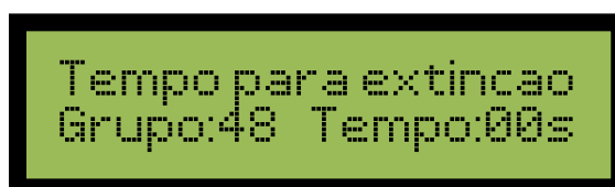
Figura 66 – Configuração do tempo em segundos para disparo do gás
