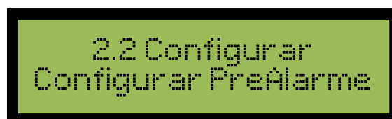
Figura 54 – Menu para habilitar ou desabilitar Pré-Alarme
